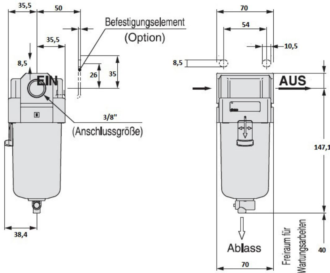
**Druckluftfilter 703S-36A** zum Entfernen übermäßiger Feuchtigkeit und fester Fremdkörper in der Druckluftleitung. Der Filter ist ausgestattet mit schwimmergesteuertem, automatischem Kondensat- ablass.
