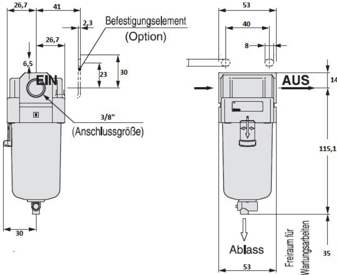
**Druckluftfilter 703S-24AN** zum Entfernen übermäßiger Feuchtigkeit und fester Fremdkörper in der Druckluftleitung. Der Filter ist ausgestattet mit schwimmergesteuertem, automatischem Kondensatablass.
