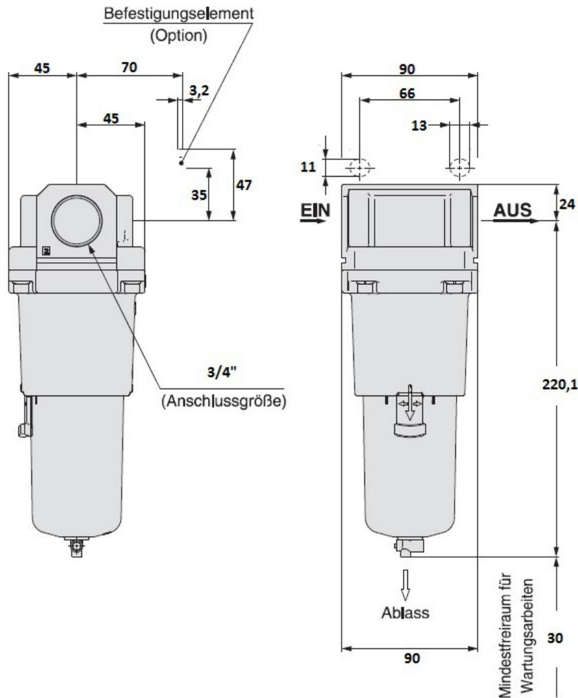
**Druckluftfilter 703S-40A** zum Entfernen übermäßiger Feuchtigkeit und fester Fremdkörper in der Druckluftleitung. Der Filter ist ausgestattet mit schwimmergesteuertem, automatischem Kondensatablass.
