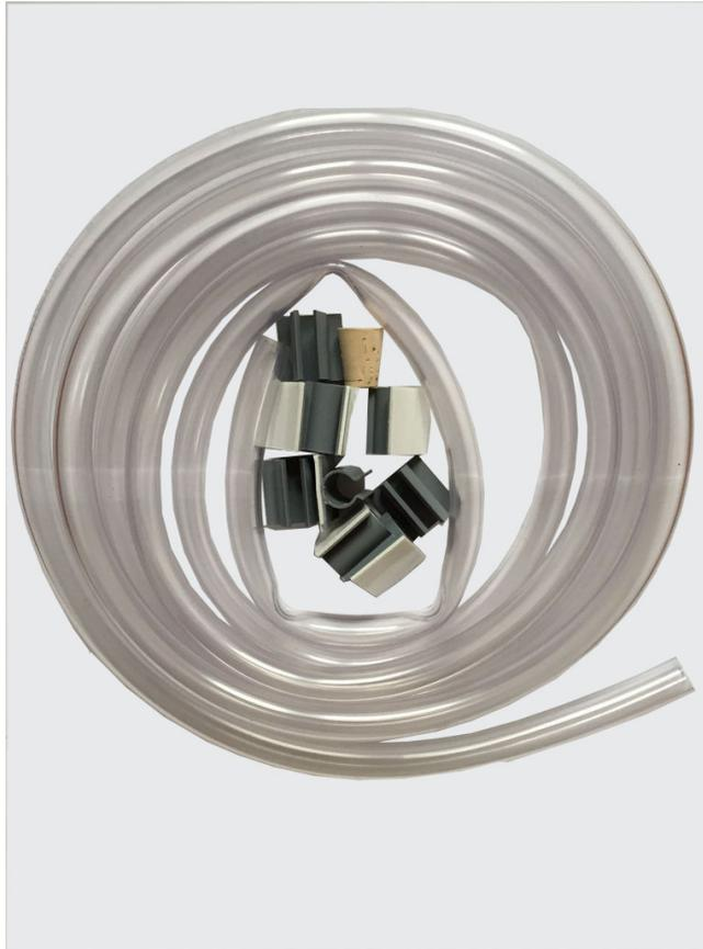
Das Luftleitsystem für Vortex Cooler ist dazu bestimmt die aus dem Cooler austretende kalte Luft optimal im Schaltschrank zu verteilen. Es wird im Schrank verlegt, mehrfach angebohrt und am Ende durch einen Stopfen verschlossen. Mit diesem System können auch hitzeanfällige Bauteile im Schrank direkt gekühlt werden. Ein anschauliches Video zur Montage unter Videos.
